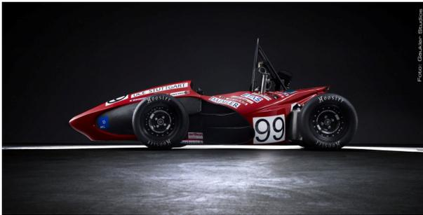
Unser Fahrzeug baut auf einem Gitterrohrrahmen auf und wird von einem 4-Zylinder Motorradmotor mit 600ccm Hubraum angetrieben. Die Leistung wird durch die Programmierung eines neuen Motorsteuergerätes optimiert. Zusätzlich verwenden wir für die Außenhaut hoch modernere Faserverbundwerkstoffe.
